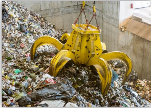
Kuva 2. Jätettä jätebunkkeriin syöttävä kahmari.
